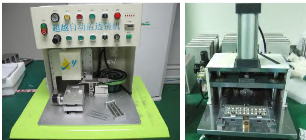
图 3.9 自动盖透镜机 左：分立型 右：透镜片型
