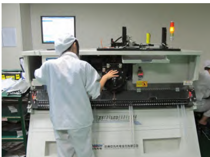
图 4.2 大功率 LED 自动分光机
