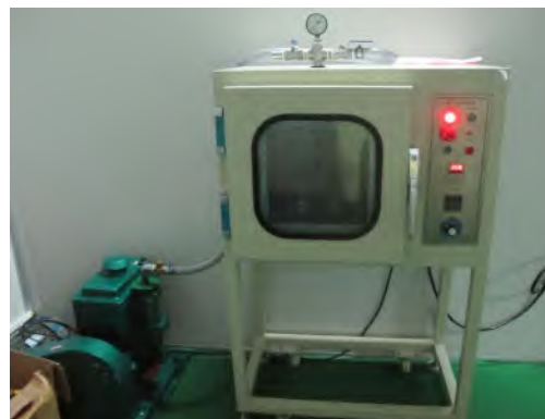
图 3.5 配胶子工序之抽真空机
