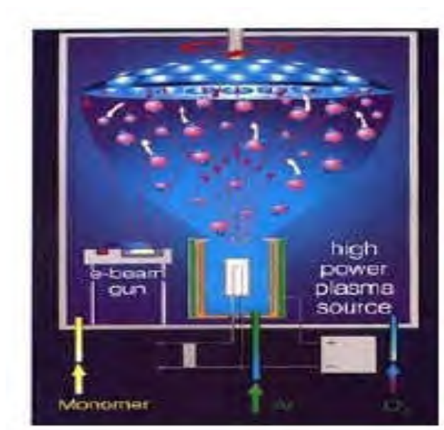
图 2.2.3-23 离子辅助沉积示意图
