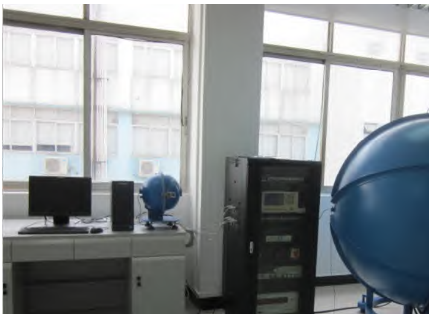
图 5.1 LED 光色电综合测试系统
