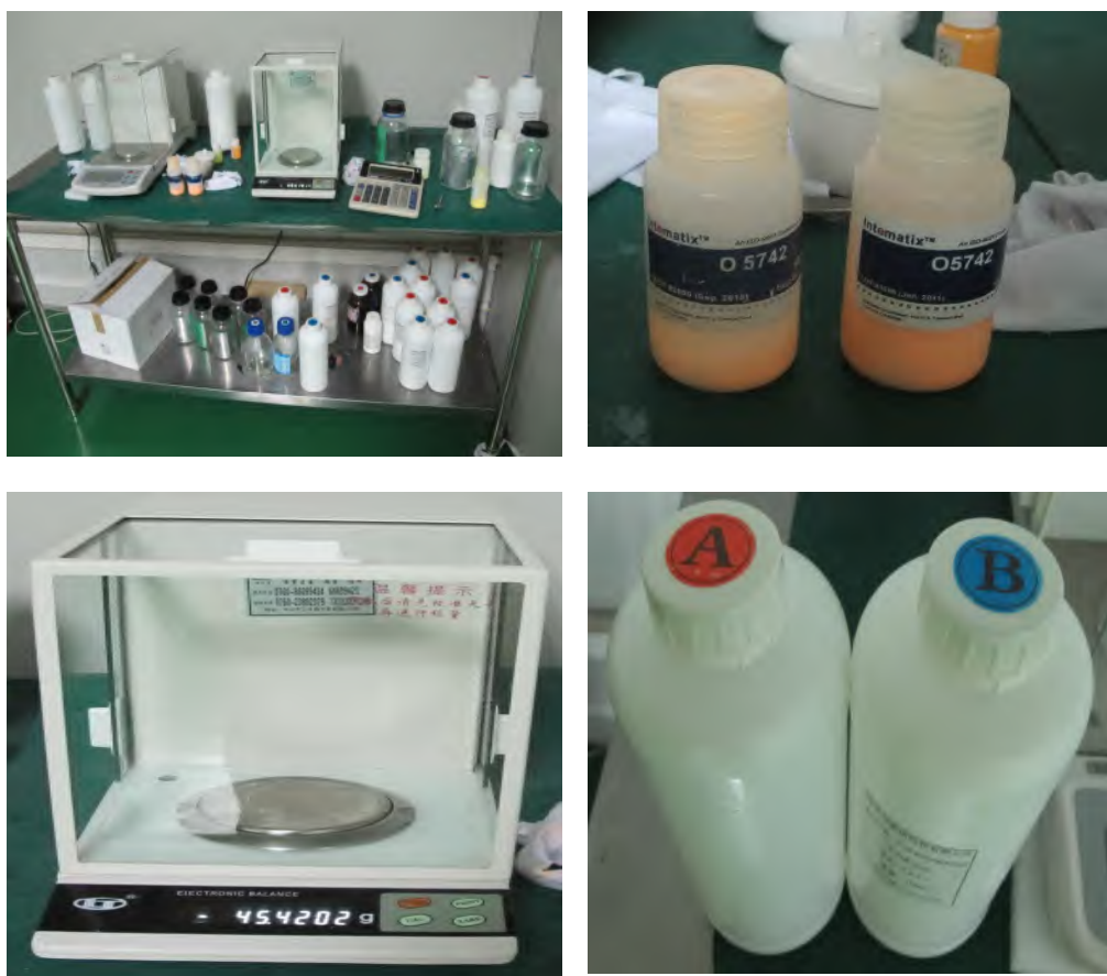
图 3.3 配胶子工序之电子天平称量物料
