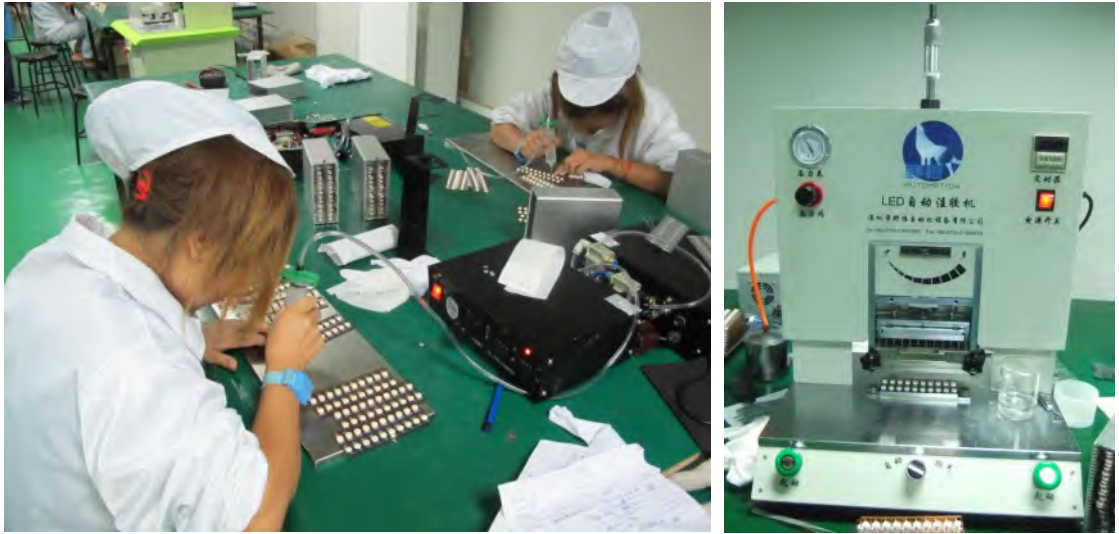
图 3.11 灌胶设备与操作 左：手动 右：自动
