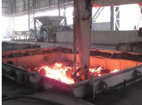
图 14 钢渣常压池式热闷处理图
