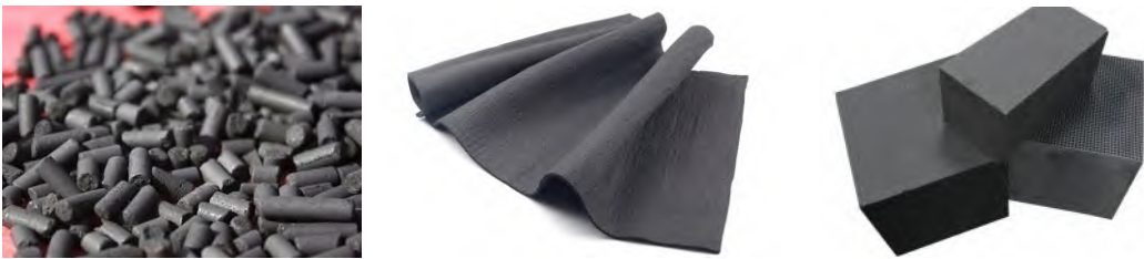
图 7 常用 VOCs 处理炭吸附材料（颗粒炭、碳纤维、蜂窝炭）
